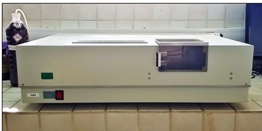
Figure 12 : Analyseur AMA 254 utilisé pour mesurer la concentration de mercure dans la chair des poissons
